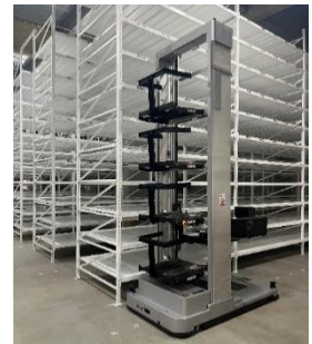
●自動入庫ケース倉庫
